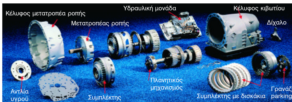
Σχήμα 1.35: Κιβώτιο ταχυτήτων σε τομή με θέσεις εξαρτημάτων.
